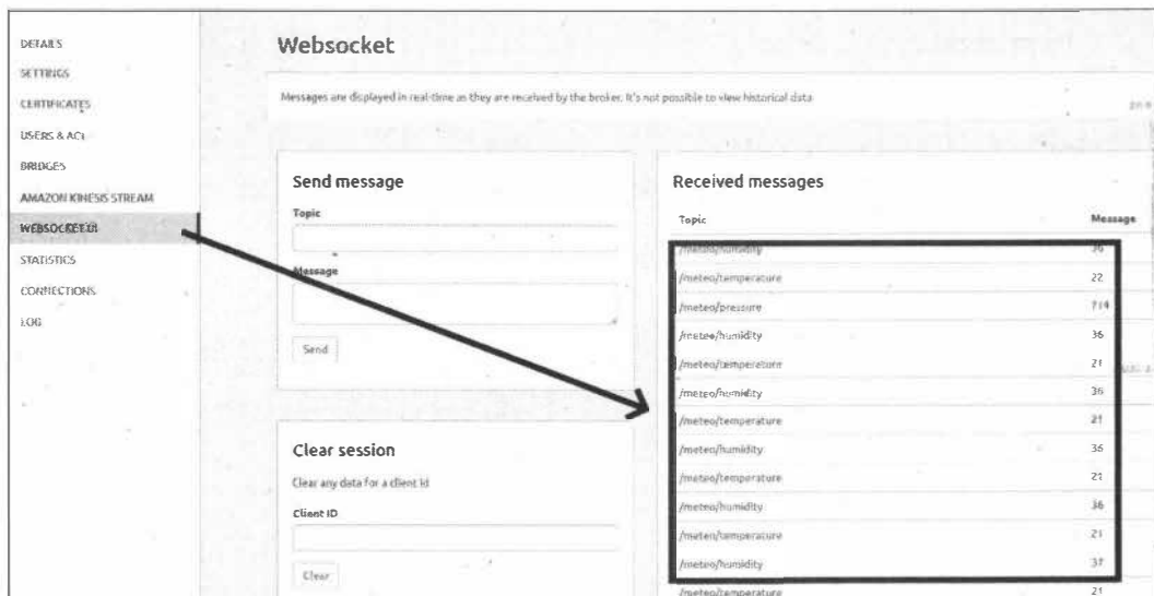
Рис. 4.4. Получение на брокере данных температуры и влажности, отправленных с датчика DHT11 в сервис www.cloudmqtt.com
