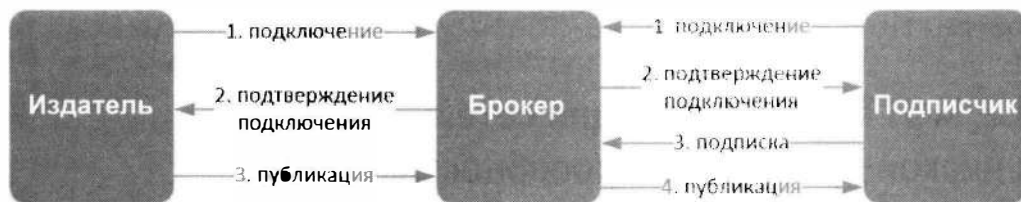
Рис. 4.1. Схема взаимодействия по протоколу MQTT
